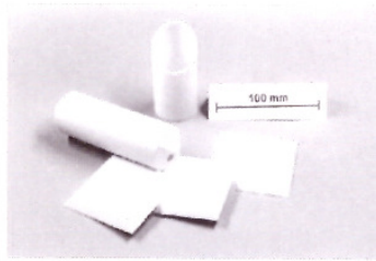
Bild 2a Weiterführung des Formgebungsverfahrens Druckguß durch Entwicklung von speziellen Binderkomponenten ( Al_2O_3 -Hohl- und Vollguß)
