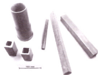
Bild 2a Weiterführung des Formgebungsverfahrens Druckguß durch Entwicklung von speziellen Binderkomponenten ( Al_2O_3 -Hohl- und Vollguß)
